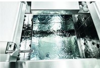
Durch den serienmäßigen Zweiseitenüberlauf entsteht eine permanente Strömung, die zu einer intensiven Behandlung der Teile beiträgt. Gleichzeitig werden abgereinigte Kontaminationen sofort aus den Wannen ausgetragen.
