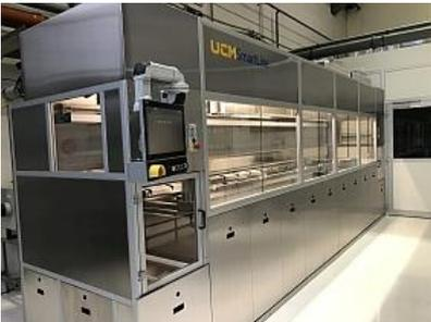
Die auf standardisierten Modulen für Reinigungs-, Spül- und Trocknungsprozesse basierende Anlage erfüllt sehr hohe Sauberkeitsanforderungen bei der Endreinigung und das bei gleichzeitig hoher Kosteneffizienz.
