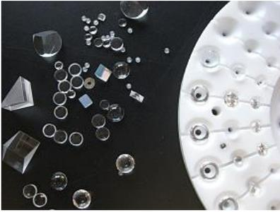
Um eine Beschädigung der beschichteten Präzisionsoptiken während des Reinigungsprozesses und der dabei stattfindenden Drehbewegung mit bis zu 1.500 UpM zu verhindern, werden sie in speziellen Aufnahmen platziert.
