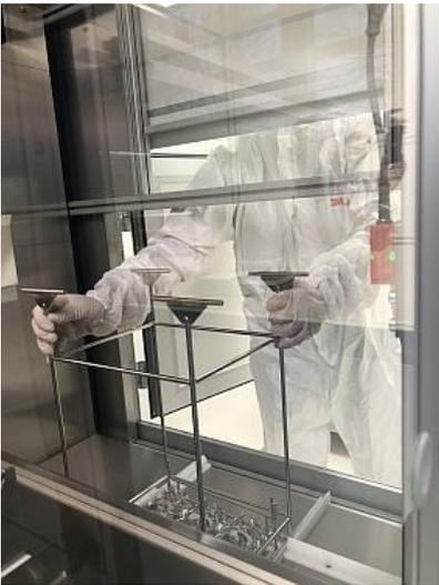
Die Ausgabe der gereinigten Linsensysteme erfolgt in einen Reinraum, in dem vor der Montage eine 100 %-Kontrolle stattfindet.
