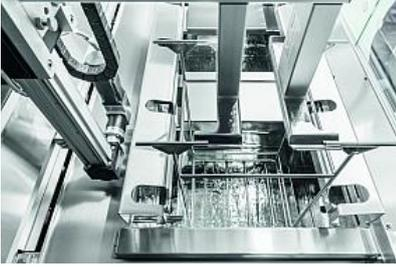
Durch das serienmäßig integrierte Transportsystem mit Servoantrieb kann nach der letzten Spüle ein Lift-Out für die Vortrocknung realisiert werden.
