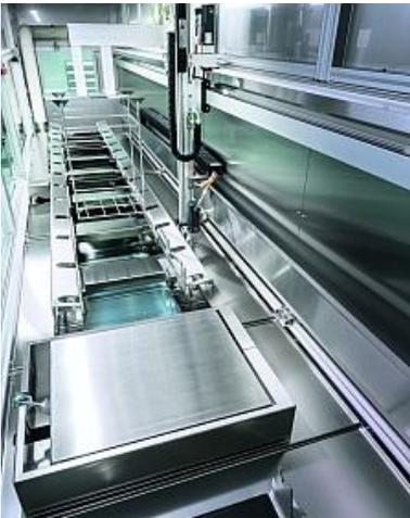
Die modular aufgebaute Endreinigungsanlage verfügt über sieben Nassstationen für das Reinigen, Passivieren, Neutralisieren und Spülen sowie einen Vakuumtrockner.
