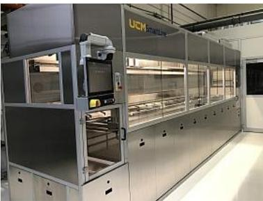
Das auf standardisierten Modulen basierende Anlagenkonzept ermöglicht die individuelle Konfiguration von Ultraschall-Tauchreinigungsanlagen für die Zwischen- und Endreinigung – auch mit direkter Anbindung an einen Reinraum.
