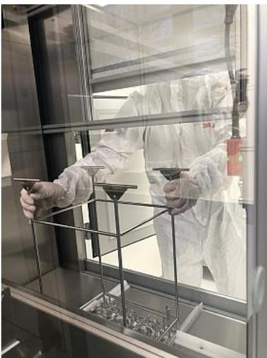
Die Ausgabe der endgereinigten Teile erfolgt in den Reinraum. Durch das konsequente Monitoring und den Abgleich der Prozessparameter mit den validierten Werten werden „bad Baskets“ vor dem Reinraum ausgeschleust.
