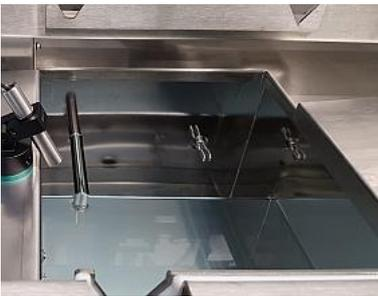
Das neu entwickelte Acoustic Performance Measurement (APM)-System ermöglicht, Ultraschallfrequenz und -leistung an jeder Behandlungsstation und für jede Charge inline zu überwachen und zu dokumentieren.
