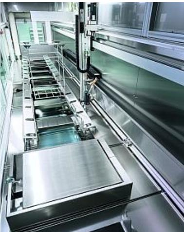
L'installation modulaire de nettoyage final dispose de sept stations humides pour le nettoyage, la passivation, la neutralisation et le rinçage, ainsi que d'un séchoir sous vide.
