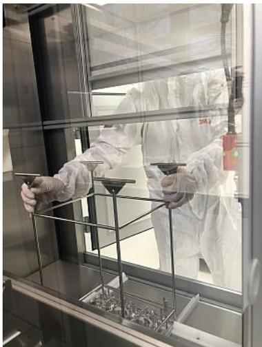
La sortie des pièces nettoyées définitivement se fait dans la salle blanche. Grâce au monitoring conséquent et à la comparaison des paramètres du processus avec les valeurs validées, les "bad baskets" sont éliminés avant la salle blanche.
