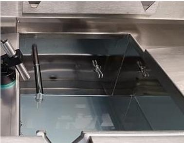
Le système Acoustic Performance Measurement (APM) récemment développé permet de surveiller et de documenter en ligne la fréquence et la puissance des ultrasons à chaque poste de traitement et pour chaque charge.
