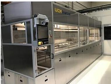
Le concept d'installation basé sur des modules standardisés permet de configurer individuellement des installations de nettoyage par immersion à ultrasons pour le nettoyage intermédiaire et final - également avec un raccordement direct à une salle blanche.
