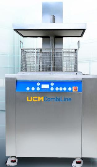
Die UCMCombiLine Ultraschallreinigungsanlage für manuelle Arbeitsplätze kombiniert in verschiedenen Größen eine oszillierende Korbbewegung für gesteigerte Reinigungswirkung und optimiertes Abtropfen. Sie lässt sich als Einzelgerät oder modular mit einem oder mehreren Spülbehältern (mit/ohne Heizung), Spritzreinigung und Heißlufttrockner flexibel an individuelle Anforderungen anpassen.
