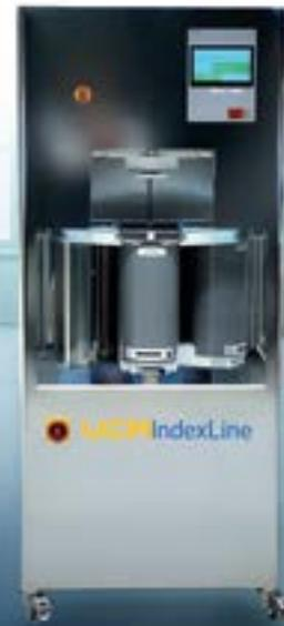
Die UCMIndexLine ist eine sehr kompakte Rundtaktanlage mit sechs Reinigungsstationen für die Präzisionsreinigung auf wässriger Basis. Mit den integrierten Reinigungs- und Spülstationen, mit und ohne Ultraschall, lassen sich nahezu alle Prozesse abbilden. So sind jede Prozessreihenfolge sowie beliebig viele Prozessfolgen darstellbar. Die Anlage ist speziell auf sehr kleine und komplexe Bauteile zugeschnitten.
