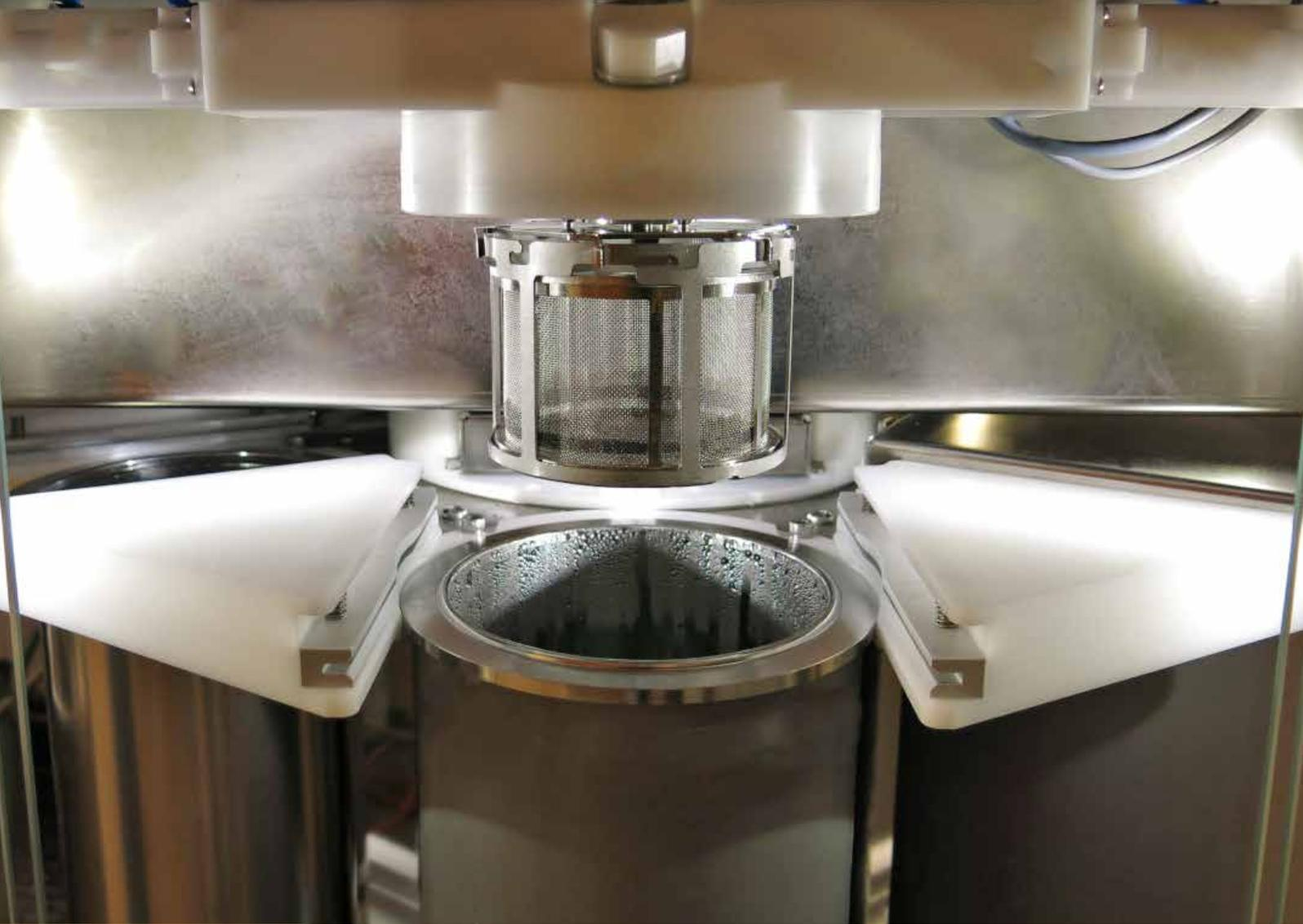
L'UCMIndexLine est une installation à cycle rotatif très compacte avec six stations de nettoyage pour le nettoyage de précision à base aqueuse. Avec les stations de nettoyage et de rinçage intégrées, avec ou sans ultrasons, presque tous les procédés sont réalisables. Ainsi, chaque séquence tout comme un nombre illimité de séquences sont réalisables. L'installation est spécialement conçue pour le nettoyage de très petites pièces à géométries complexes.
