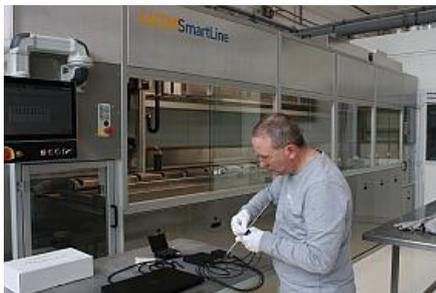
Ultraschalleistung und -frequenz beeinflussen die Reinigungswirkung entscheidend. Diese Prozessparameter werden daher einmal jährlich im Rahmen einer Servicevereinbarung mit einer portablen Version des APM-Systems auf korrekte Funktion überprüft.
