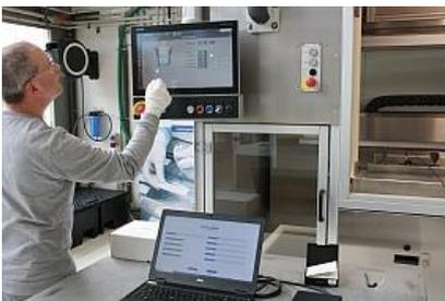
Als Referenz dienen beim Site Acceptance Test (SAT) ermittelte Werte der praktisch neuen Ultraschalleinheiten, die in jeder Ultraschallwanne einzeln vermessen werden.
