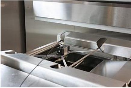
Im Gegensatz zu Hydrophonen arbeitet das APM-System berührungslos und bewegungsfrei, was reproduzierbare Messungen ermöglicht. Für die Kontrollmessung wird das Richtmikrofon durch eine Halterung auf das jeweilige Ultraschallbecken ausgerichtet und erfasst Frequenz und Druckpegel.
